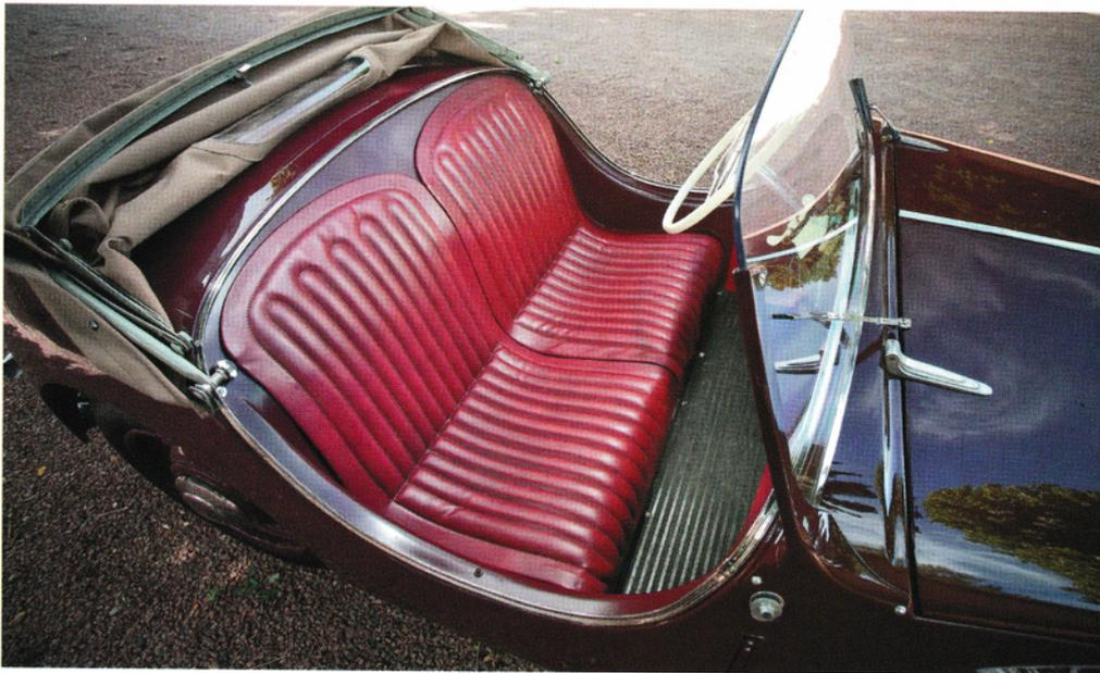
Très confortables, les sièges reçoivent un astucieux système de ressorts suspendus.
